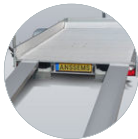
Aluminium rijplaten in geïntegreerde rijplaathouders
