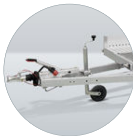
Lange dissel uit stalen kokerprofielen
