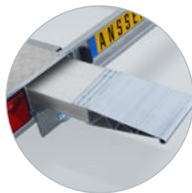
Aluminium rijplaten in geïntegreerde rijplaathouders
