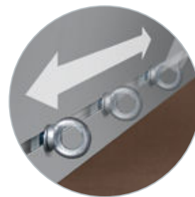
Ook een bindrail aan de binnenzijde van de laadbak
