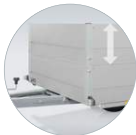
Accessoire: opzetborden, laadbakhoogte is nu 65 cm
