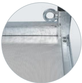
Aluminium laadvloer en bindogen in de hoeken
