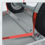
Bevestigingsgaten voor wielstops
