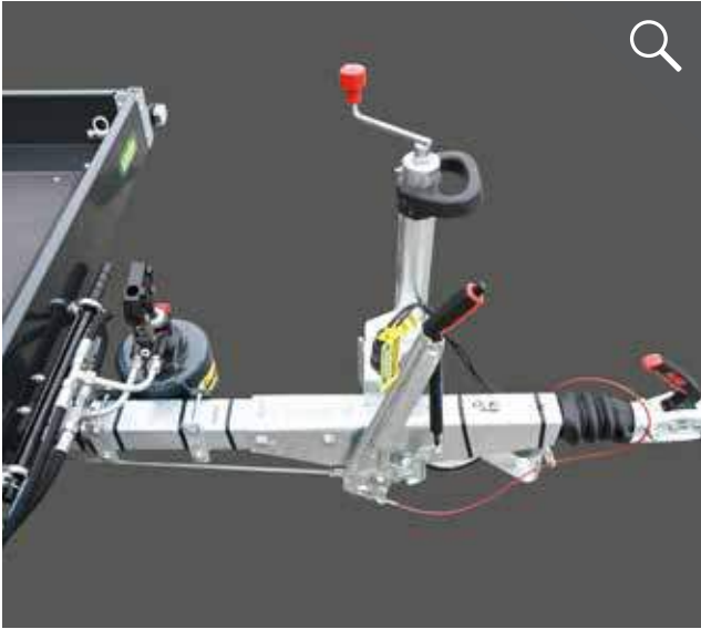
Verstärktes und automatisches Stützrad mit Rangiergriff
