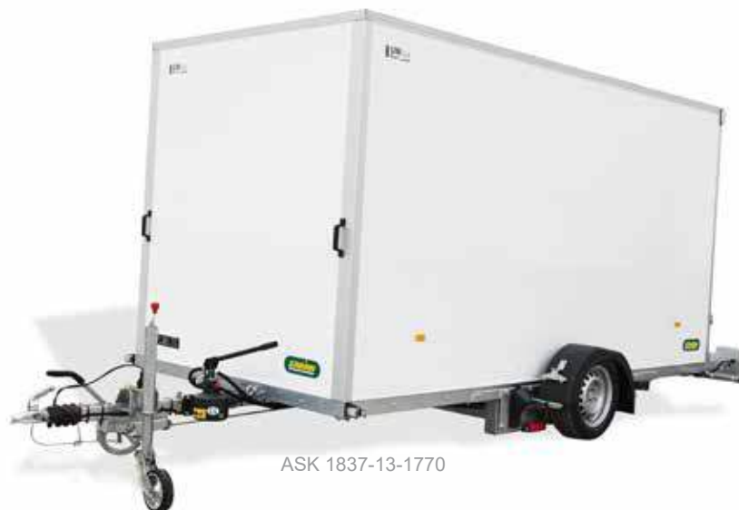
Aufbau aus Unique Panels ohne Stoß
